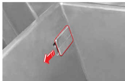
2. Извлеките перчаточный ящик из приборной панели, переместив левую сторону отделения в направлении стрелки.
