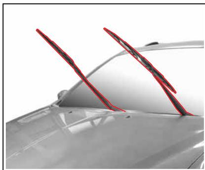
1. Поднимите рычаг стеклоочистителя с ветрового стекла.
