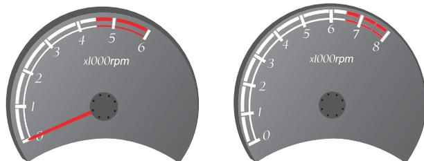
Тахометр показывает скорость вращения двигателя (оборотов/мин.). Отображаемое значение нужно умножить на 1000.
