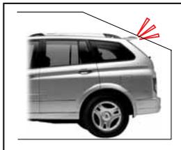
**Чем ближе автомобиль приближается к объекту, тем чаще становится интервал между звуковыми сигналами.**
