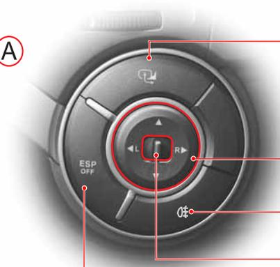
Кнопка закрытия наружного зеркала заднего вида
