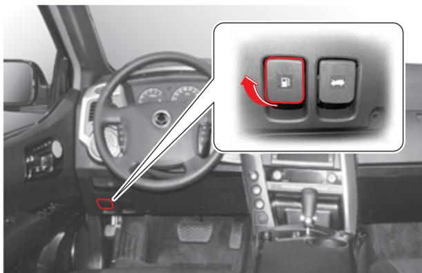
1. Откройте дверцу горловины для топлива (A), потянув рычаг с левой нижней стороны рулевого колеса.
