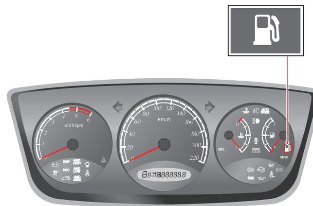
Этот индикатор загорается, когда заканчивается топливо. Время включения индикатора зависит от условий эксплуатации автомобиля и дорожных условий. Не ждите, пока загорится этот индикатор, чтобы заправить автомобиль. Рекомендуется залить топливо в бак сразу же, как только включится индикатор.
