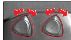
Вы можете отрегулировать угол наклона и высоту подушек сиденья, поворачивая регулировочную ручку, расположенную на боковой стороне сиденья.
