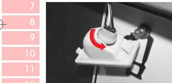
3. Извлеките корпус лампы, повернув соединитель..
