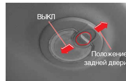
При перемещении переключателя в направлении к задней двери лампа включается, когда задняя дверь открыта. При перемещении переключателя в противоположную сторону лампа выключается, и не включится, если открыть заднюю дверь.
