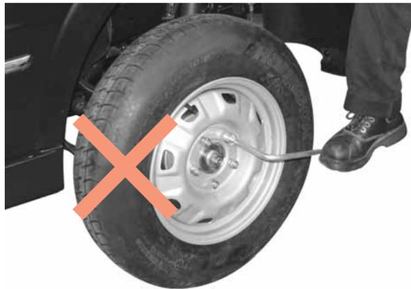
При чрезмерном затягивании возможно повреждение гаек. Не перетягивайте гайки крепления колеса, нажимая на ключ ногой или используя вспомогательные рычаги.
