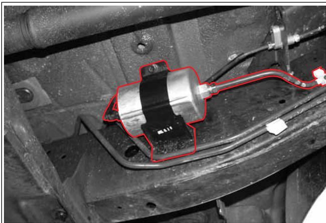
Если фильтр загрязнен, подача топлива снизится, основные компоненты будут повреждены вследствие проникновения в систему загрязненных материалов, а рабочие характеристики каталитического конвертера (каталитического нейтрализатора отработавших газов) будут ухудшены.
