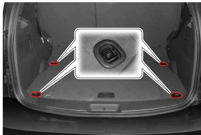
На днище багажного отделения имеются крючки для крепления багажа.
