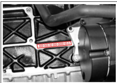
**Бензиновый двигатель:** Номер двигателя отштампован в донной части блока цилиндров со стороны выхлопного коллектора
