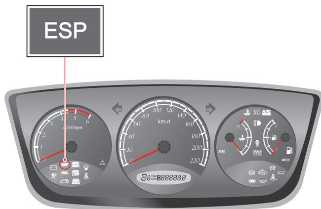
Если вы нажмете выключатель ESP OFF, система ESP прекратит работу и на приборной панели включится индикатор. Если функция ESP включена, индикатор мигает.
