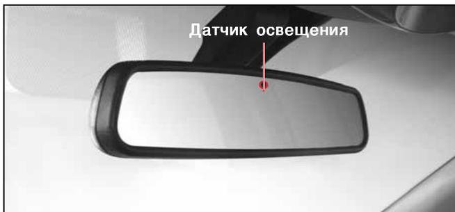
Степень отражения внутреннего зеркала заднего вида автоматически регулируется в зависимости от интенсивности света фар автомобиля, движущегося сзади.
