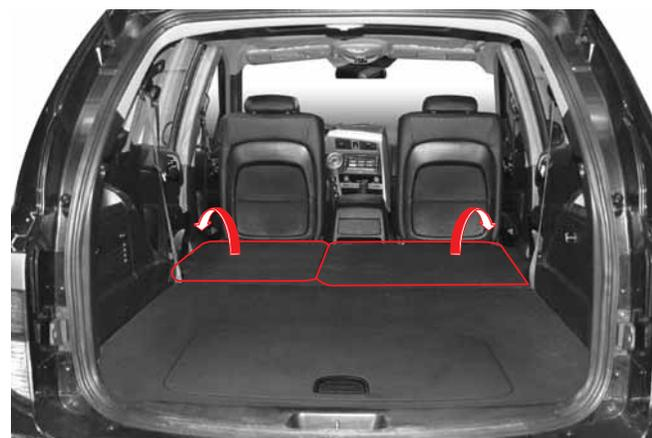
2. Чтобы освободить максимум багажного пространства, следует наклонить спинки сидений второго ряда, пока не услышите щелчок. Убедитесь в том, что спинки сидений зафиксированы.
