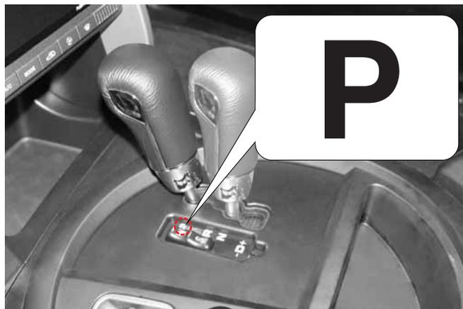
Используйте стояночное положение, чтобы припарковать автомобиль, прогреть двигатель, или оставить автомобиль в этом месте на продолжительное время.
