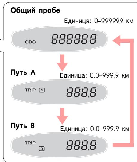
\* При установке измерения в милях, суточный счетчик пути и индикатор пробега указывают пробег в милях.
