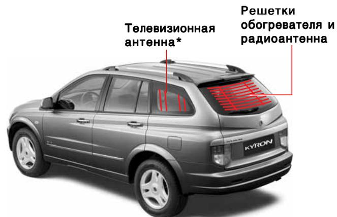
Оконная антенна (для частотных диапазонов FM и AM) находится в верхней и нижней части заднего стекла; решетки обогревателя расположены в центральной части заднего стекла. Телевизионные антенны установлены с обеих сторон заднего стекла.
