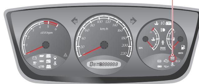
Когда ключ зажигания поворачивается в положение ON, этот индикатор включается и выключается или горит некоторое время. Когда запальные свечи достаточно разогреваются, индикатор отключается. Если в автомобиле используется двигатель с прямым впрыском, этот индикатор может включиться на очень короткое время или вообще не включиться.
