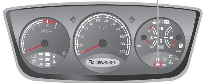
Этот предупреждающий индикатор включается при включении зажигания и должен отключиться, если система находится в нормальном состоянии. Если система EBD функционирует ненормально, включается индикатор EBD.
