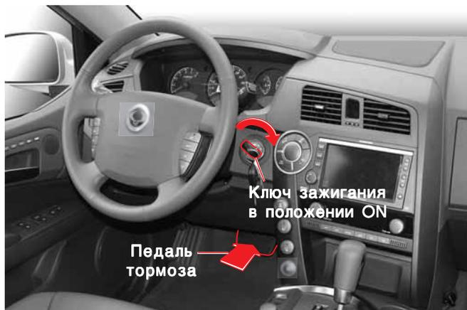
Для перемещения рычага селектора из положения "P" ключ зажигания должен находиться в положении ON; педаль тормоза должна быть нажата.
