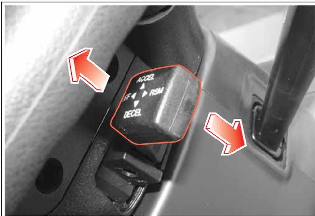
Даже когда круиз-контроль отключен, можно восстановить последнюю заданную скорость движения, нажав на кнопку RSM (восстановление) на рычаге круиз-контроля, если автомобиль движется со скоростью более 36 км/час; для этого не нужно нажимать на педаль акселератора. Последнюю заданную скорость нельзя восстановить после выключения зажигания, так как в этом случае значение заданной скорости не сохраняется.
