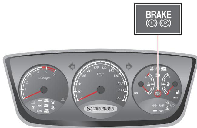
Этот индикатор включается, когда включен стояночный тормоз и/или когда уровень тормозной жидкости ниже указанного.
