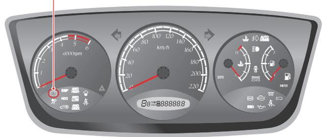
Этот индикатор включается при включении зажигания и выключается при запуске двигателя. Если после запуска двигателя индикатор не выключается, или включается во время движения автомобиля, это означает наличие неисправности. В этом случае систему зарядки должен проверить дилер или авторизованный сервисный центр Ssangyong.
