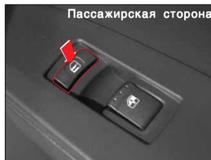
При нажатии выключателя блокировки/разблокировки дверей, когда все двери, включая дверь заднего отделения, закрыты, все двери будут разблокированы. При повторном нажатии этого выключателя все двери будут заблокированы.
