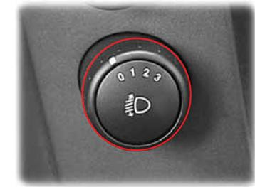
Когда включены фары ближнего света, отрегулируйте угол освещения в соответствии с нагрузкой на автомобиль.
