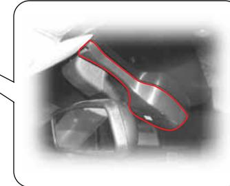
Этот датчик определяет интенсивность наружного освещения, чтобы определить время автоматического включения или выключения передних и задних фар, если выключатель освещения установлен в положение "AUTO".
