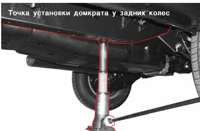
3. Поместите верхнюю часть домкрата непосредственно под точки на кузове, предназначенные для поддомкрачивания автомобиля.
