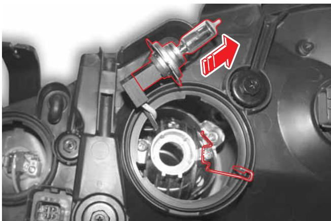
1. Снимите крышку с извлеченного корпуса передней фары.
