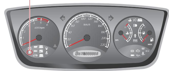
При включении зажигания этот индикатор должен включиться, а затем выключиться; это означает, что подушка безопасности находится в исправном состоянии.
