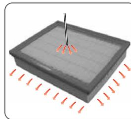
Продуйте фильтрующий элемент сжатым воздухом, направляя струю в сторону, противоположную направлению обычного потока воздуха
