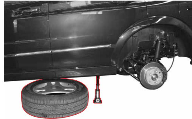
6. Снимите колесо и поместите его под корпус автомобиля. Это позволит максимально снизить опасность при соскальзывании домкрата.
