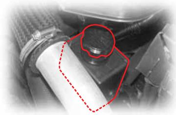
Проверьте уровень жидкости на ровной поверхности при выключенном двигателе. Уровень жидкости должен быть между отметками MAX и MIN на стержне крышки бачка. Если уровень упадет до отметки MIN или ниже, заполните резервуар требуемой жидкостью. Используйте только рекомендованные жидкости. Разница между отметками MIN и MAX соответствует колебанию объема жидкости механизма рулевого управления в холодную и горячую погоду.
