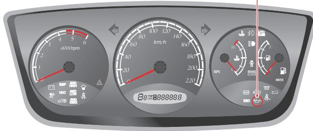
Этот индикатор загорается при включении зажигания и гаснет при запуске двигателя.
