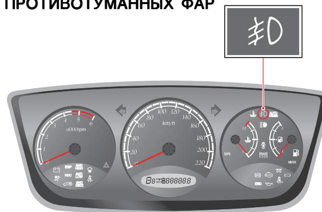
При включенных передних или задних фарах противотуманные фары включаются, если переключатель противотуманных фар будет установлен в положение ON. После этого включится индикатор противотуманных фар на приборной панели.
