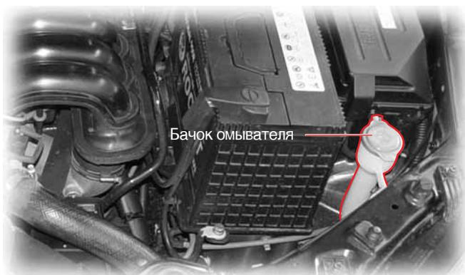
Рекомендуется часто проверять уровень жидкости в бачке омывателя и доливать по мере необходимости жидкость, рекомендованную производителем.
