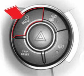
При нажатии этой кнопки система HDC готова к использованию. При этом загорается зеленый индикатор HDC на приборной панели. При повторном нажатии кнопки система HDC деактивируется и индикатор выключается.
