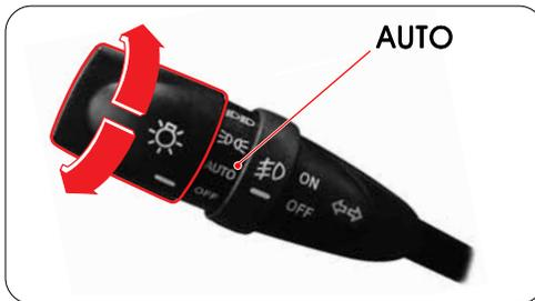
Автоматический датчик дождя и освещения определяет интенсивность наружного освещения, чтобы определить время автоматического включения или выключения передних и задних фар, если выключатель освещения установлен в положение "АВТО".
