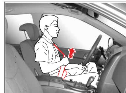
4. Потяните язычок защелки, чтобы убедиться, что он надежно закреплен. Ненадетый ремень безопасности обеспечивает защиту пассажиров значительно хуже.
