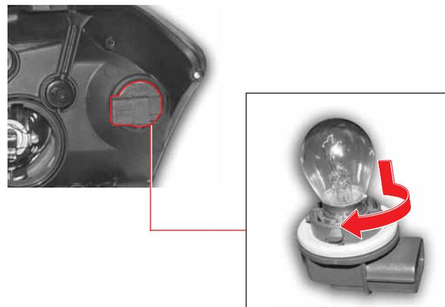
1. Отсоедините соединитель поворотного сигнала с извлеченного корпуса передней фары.
