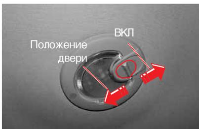
При перемещении переключателя в направлении к задней части автомобиля лампа включается. При перемещении переключателя в противоположную сторону лампа выключается. Если открыть дверь лампа включается на 30 секунд. Когда дверь закрыта, лампа выключена.
