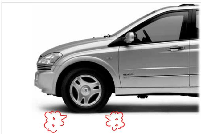
При спуске одной из шин крепко держите рулевое колесо и уберите ногу с педали акселератора. Постепенно остановите автомобиль и припаркуйтесь в безопасном месте. Замените колесо со спущенной шиной запасным колесом. Описание процедуры приведено в разделах, посвященных запасному колесу.
