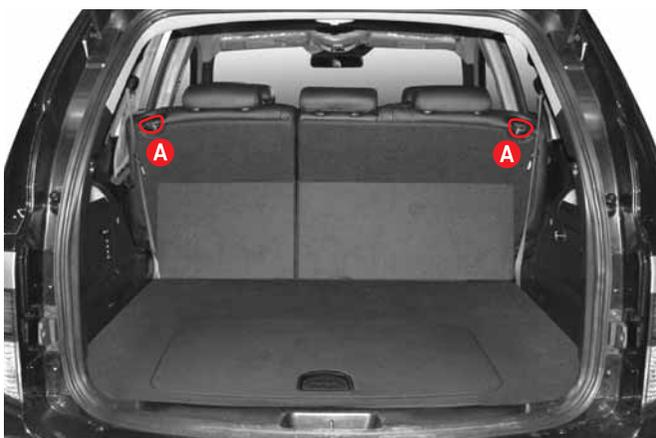
1. Потяните вверх ручку регулировки наклона спинки сиденья второго ряда **A**.
