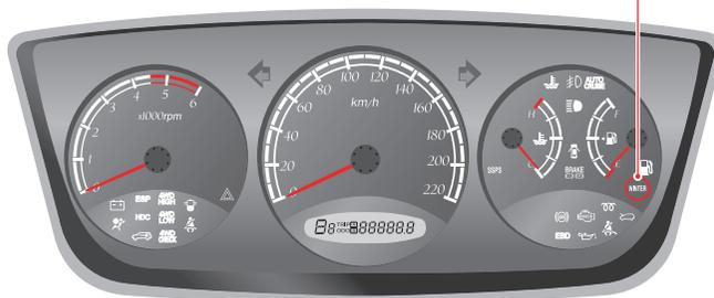
Этот индикатор горит, если нажат выключатель зимнего режима (W) рядом с рычагом селектора.
