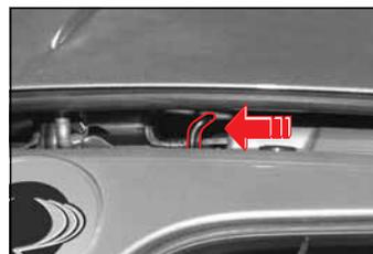
2. Слегка поднимите капот двигателя и поднимите предохранительный рычажок. Затем поднимите капот полностью.
