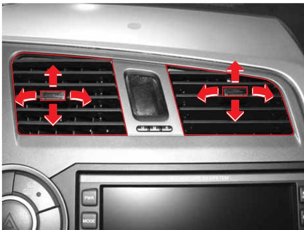
Вы можете отрегулировать направление воздушного потока, перемещая ручку в горизонтальном или вертикальном направлении.
