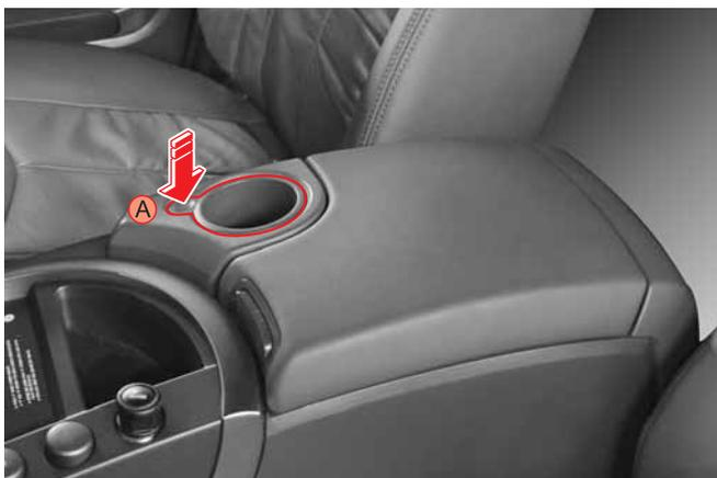
Держатель поднимается при нажатии кнопки (A).
