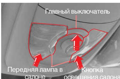
При перемещении этого выключателя включаются передняя и центральная лампы салона. При повторном нажатии лампы выключаются.
