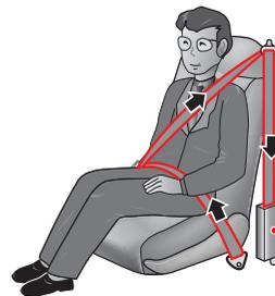
При сильном лобовом ударе преднатяжители ремней безопасности сразу же натягивают ремни безопасности, благодаря чему пассажиры остаются на сиденьях. Это обеспечивает эффективное функционирование ремней и подушек безопасности.
