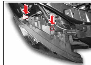
4. Отсоедините два соединителя передней фары и снимите корпус передней фары.
