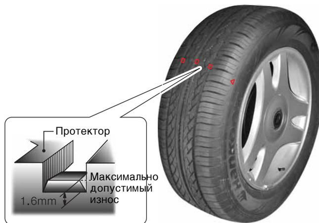
Шины вашего автомобиля оснащены встроенными индикаторами износа шины, расположенными между канавками протектора шины. Шины следует заменять, когда индикаторы износа шин появляются на двух или более расположенных рядом канавках.
