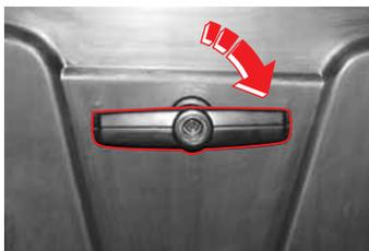
Откройте заднюю дверь и поверните ручку по часовой стрелке. Потяните заднюю дверь на себя.
