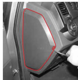
Блок предохранителей расположен слева от приборной панели.
