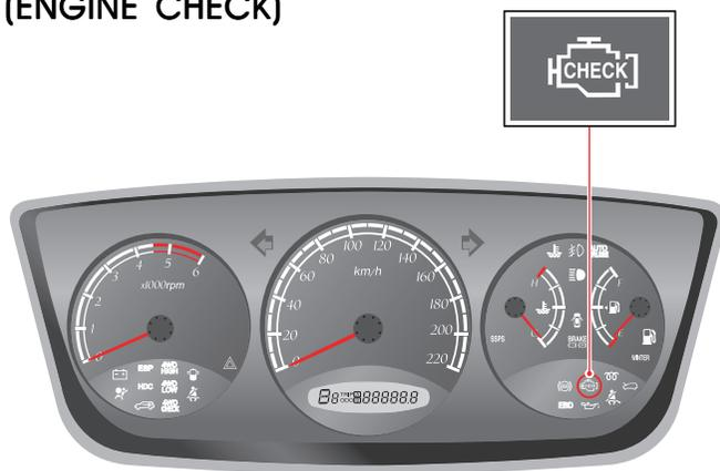
Если этот индикатор мигает или горит постоянно во время движения, это указывает на неисправность системы управления двигателем, например, датчиков.
