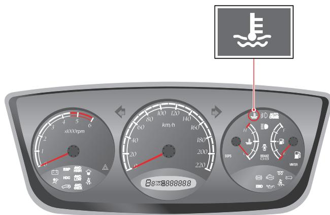
Если температура охладителя двигателя чрезмерно высока, мигает индикатор перегрева двигателя и включается звуковое предупреждение. В этом случае необходимо остановить движение в безопасном месте и дать двигателю остыть. Дополнительную информацию можно найти в главе 11 "Когда двигатель перегревается".
