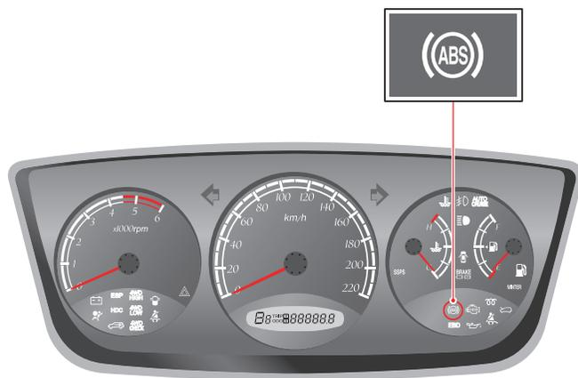
Этот предупреждающий индикатор включается при включении зажигания и должен отключиться, если система находится в нормальном состоянии.
