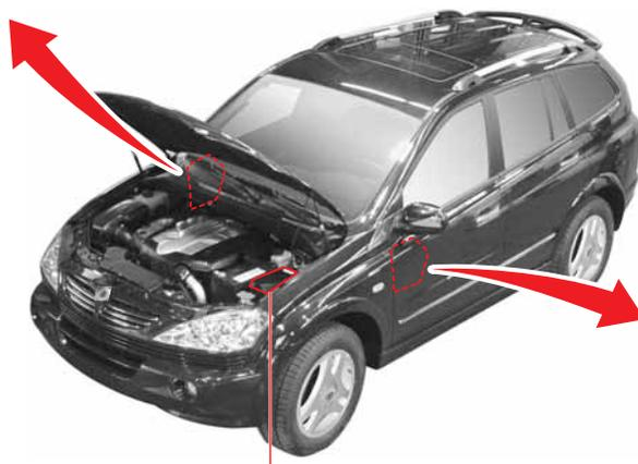
Блок предохранителей и реле двигателя отсека
