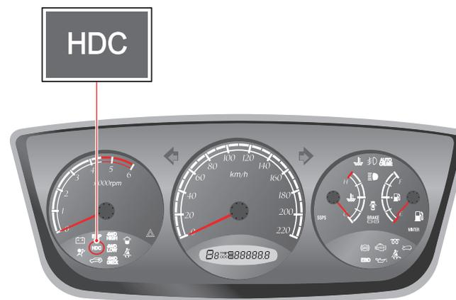
При однократном нажатии выключателя HDC система HDC готова к использованию. При этом загорается зеленый индикатор HDC на приборной панели. При повторном нажатии кнопки система HDC деактивируется и индикатор выключается.
