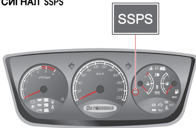
Эта лампа аварийной сигнализации загорается, когда неисправна система SSPS. При включении этого индикатора рулевое управление затрудняется.
