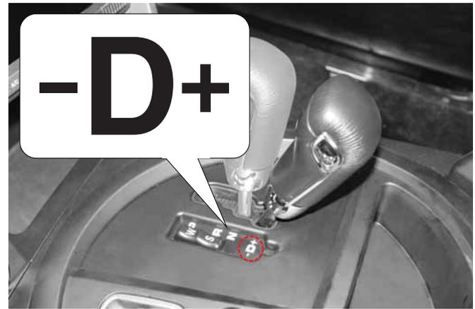
• Используйте это положение при движении в обычных условиях. При этом производится автоматическое переключение передач с **первой по пятую** в зависимости от уровня нажатия педали акселератора.
