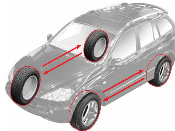
Чтобы избежать неравномерного износа шин и продлить их срок службы, необходимо проводить осмотр и переустановку шин каждые 5000 км.
