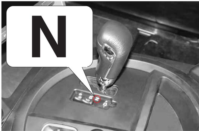
В этом положении двигатель не передает крутящий момент на колеса, и автомобиль не движется. Однако в целях безопасности используйте тормоз, когда автомобиль не движется.
