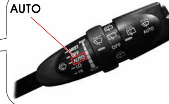
4 Регулирует скорость работы стеклоочистителя в зависимости от силы дождя.
