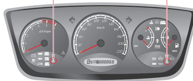
Если ключ зажигания повернут в положение ON, и ремень безопасности водителя не пристегнут, загорается сигнализатор и звучит звуковой сигнал. Сигнализатор и звук выключатся, как только водитель пристегнет ремень безопасности.
