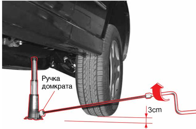
4. Соедините домкрат, ключ для гаек крепления колеса и соединение домкрата, как показано на рисунке. Поднимите автомобиль, поворачивая комбинированный ключ по часовой стрелке до тех пор, пока колесо не оторвется от земли на 3 сантиметра.
