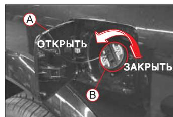
2. Отвинтите колпачок горловины для топлива (B), повернув его против часовой стрелки.
