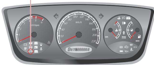
Этот индикатор загорается только на 0,5 секунды при связи блока управления двигателем с ключом зажигания (при пуске двигателя).
