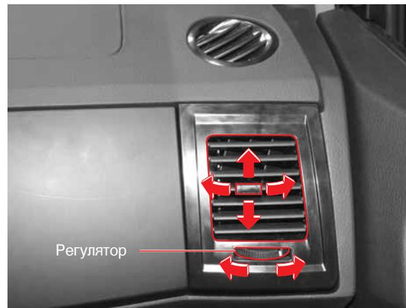
Вы можете отрегулировать направление воздушного потока, перемещая регулятор отверстия для выпуска воздуха.
