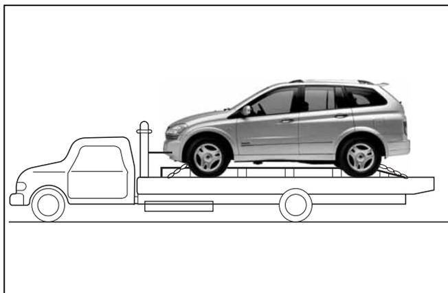
Во избежание повреждений неисправный автомобиль лучше всего перевозить на плоской платформе.
